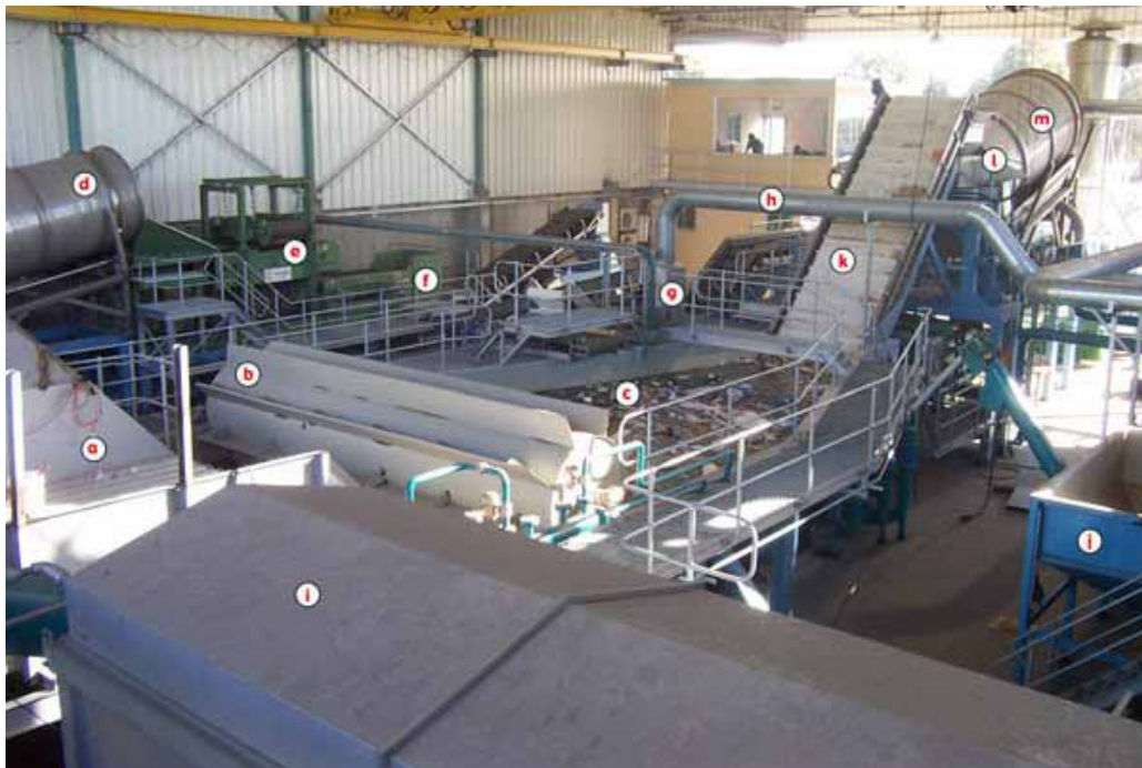
Figura 4. Interno del sottosistema meccanico di separazione/preparazione, visto attraverso l'ingresso visitatori (si veda figura 2 per orientarsi). La piattaforma di scarico è posta alle spalle del fotografo. Per avere un'idea delle dimensioni, la ringhiera arriva all'altezza della vita. (Foto scattata nelle fasi iniziali di test dell'impianto)
